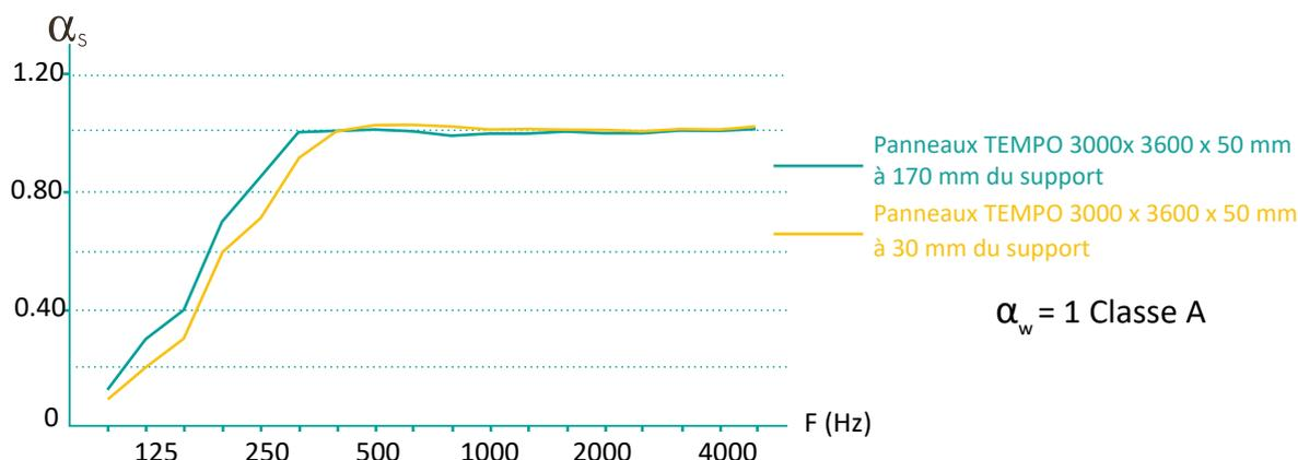
Les cloisons iso-absorbantes de chez TEMPO permettent, en plus de l'absorption acoustique définie plus haut, une bonne isolation acoustique directe.
